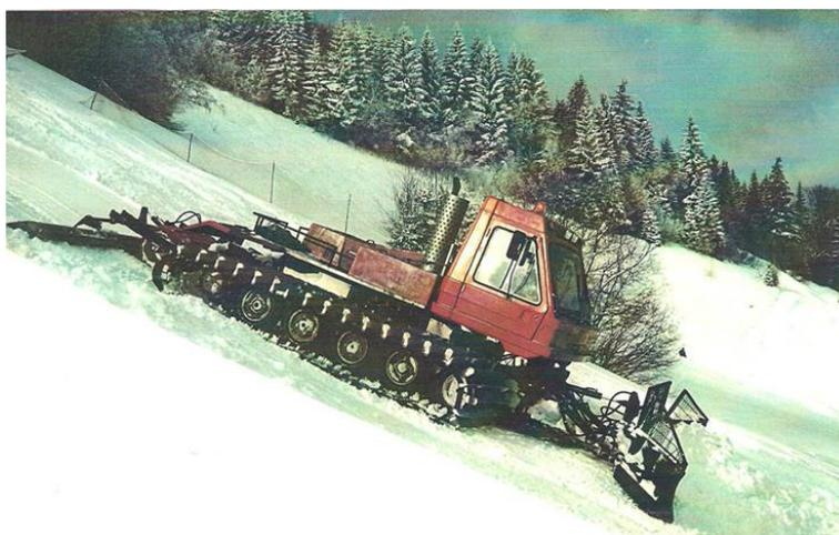
Ein schweres Modell – vorgesehen für den Einsatz in den Bergen – war mit einem speziellen KAMAZ-Motor mit 220 PS ausgestattet. Alle Baugruppen der Maschine stammten aus einheimischer Produktion.
